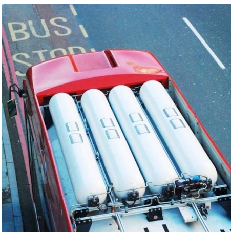
Figura 2-8: Ejemplo de ubicación de tanques de hidrógeno en un bus de pasajeros
